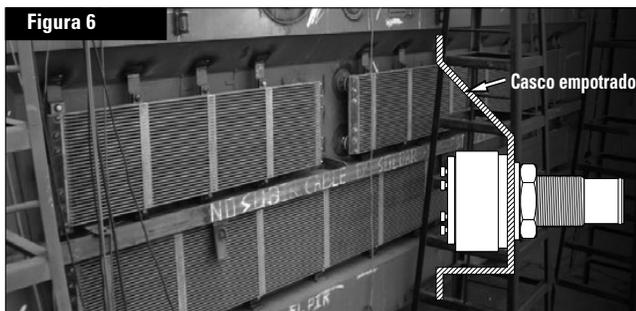
**Para aplicaciones a cero nudos.** No empotre la unidad DuraCooler® en la parte inferior de una embarcación a menos que la superficie de montaje se incline un mínimo de 20° de la parte delantera a la popa. Si se construye un revestimiento de protección alrededor de la unidad DuraCooler®, este debe permitir el libre flujo de las corrientes de convección y otros flujos.
