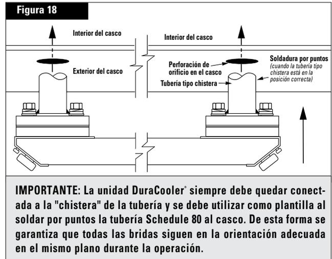
**IMPORTANTE:** La unidad DuraCooler® siempre debe quedar conectada a la "chistera" de la tubería y se debe utilizar como plantilla al soldar por puntos la tubería Schedule 80 al casco. De esta forma se garantiza que todas las bridas siguen en la orientación adecuada en el mismo plano durante la operación.
