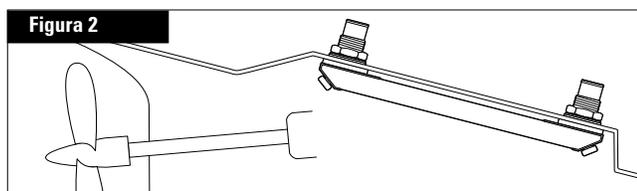
Para que la unidad DuraCooler® funcione correctamente, es esencial que el agua ambiente circule libremente por los tubos. Si el sistema está en funcionamiento a cero nudos, el calor de la unidad DuraCooler® se disipará únicamente a través de las corrientes de convección.
