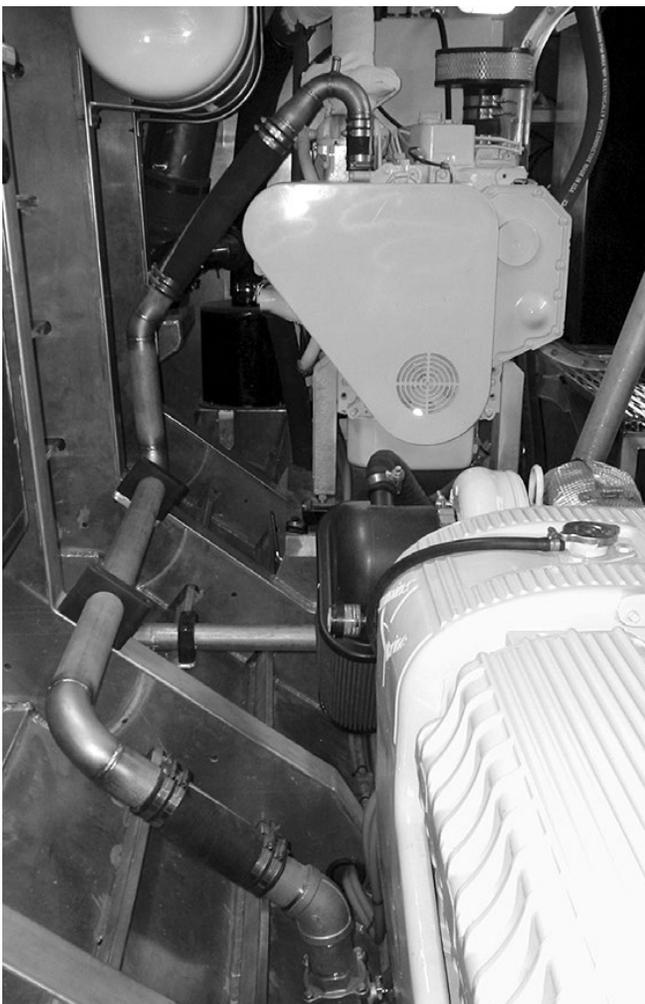
No hacer nunca ensayos de presión, ni poner en marcha la unidad DuraCooler® con una presión superior a 2,5 kg/cm<sup>2</sup> (35 psi). Es importante que rellene completamente la unidad con refrigerante y realice una prueba de presión antes de arrancar la embarcación. Las pruebas de presión que superen los 2,5 kg/cm<sup>2</sup> pueden reventar las tuberías.
