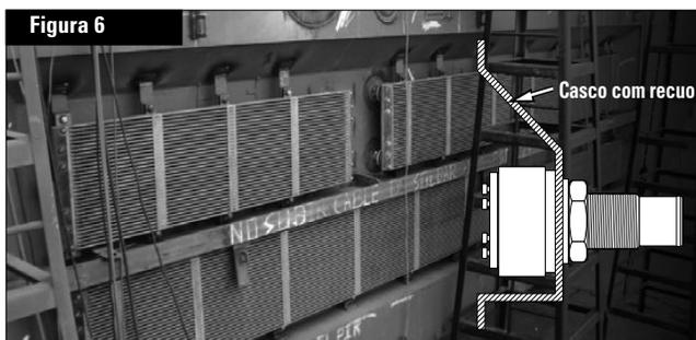
**Para aplicações a velocidade zero.** Não recue o DuraCooler® na parte inferior de uma embarcação, a menos que a superfície de montagem se incline no mínimo 20° da frente para a popa. Qualquer proteção em torno do DuraCooler® deve ser construída de forma a permitir a livre circulação de correntes de convecção e outros fluxos.
