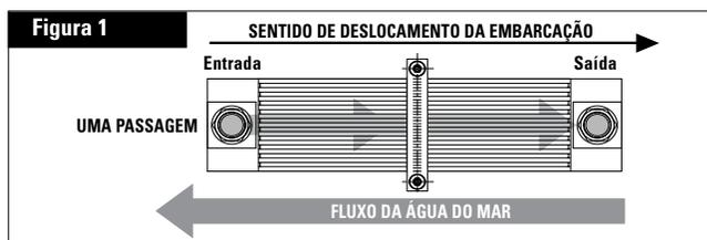
**Um arrefecimento de quilha eficiente depende do fluxo contínuo de água pelo DuraCooler®.**
