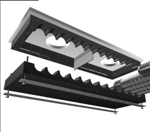
7. Coloque las juntas de estanquidad en las ranuras del cabezal de la cubierta superior (una solución de agua jabonosa sobre las juntas puede ayudar a que se asienten). Para un sellado adecuado, es importante que las juntas de los manguitos estén situadas en la parte exterior de los tubos, de manera que los bordes de los mismos estén al mismo nivel que los bordes externos de los cabezales. (Fig. 13)
