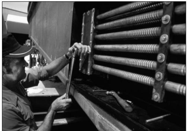
IMPORTANTE: Vuelva a apretar todos los tornillos después de una hora ya que el caucho se habrá solidificado por compresión para entonces.
