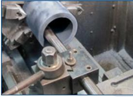
De forma general, los rodamientos DuraBlue® se producen con técnicas estándar de un taller de maquinaria convencional. Los métodos que se utilizan con el latón, el aluminio o el lignum vitae se aplican a DuraBlue®. Se
