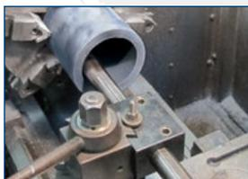
En général, le palier DuraBlue® est usinable en utilisant des techniques d'atelier d'usinage conventionnelles et standard. Les méthodes utilisées pour le laiton, l'aluminium ou le gaïac s'appliqueront au DuraBlue®. Il est
