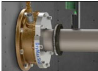
精心设计的 DryMax® 密封系统是一种为处理轴向和径向轴运动而打造的高性价比坚韧密封件,它消除了轴上的磨损,同时可以在恶劣工作条件下处理最艰巨的工作。具有内置紧急充气密封和可逆 DuraChrome® 接合环,可将使用寿命延长 2 倍并扩大干船坞之间的间隔。它用于尺寸最大为 36 英寸的轴。
