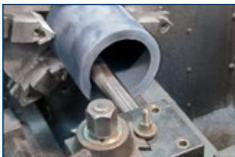
Utilisez les techniques conventionnelles d'usinage telles que celles utilisées sur le bronze, mais à sec et sans liquide de refroidissement. Il est conseillé d'utiliser un outil à pointe en carbure de tungstène afin de conserver une finition fine et lisse. Les matériaux composites DuraBlue® ne sont pas toxiques, mais il est préférable d'utiliser une extraction adéquate de la poussière pendant l'usinage.
