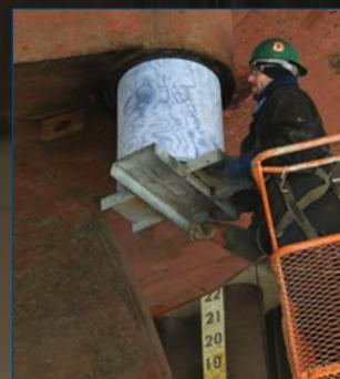
Le corps de palier doit comporter un chanfrein pour éviter de rogner le manchon lors de l'ajustement par serrage. Retenez le manchon avec un épaulement à une extrémité une fois qu'il est ajusté. Une bague de maintien peut être utilisée pour davantage de sécurité axiale.
