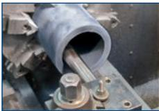
Utilize técnicas de usinagem convencionais conforme usado em bronze, mas a seco e sem líquido arrefecedor. Uma ferramenta com carboneto de tungstênio deve ser usada para manter um acabamento fino.
