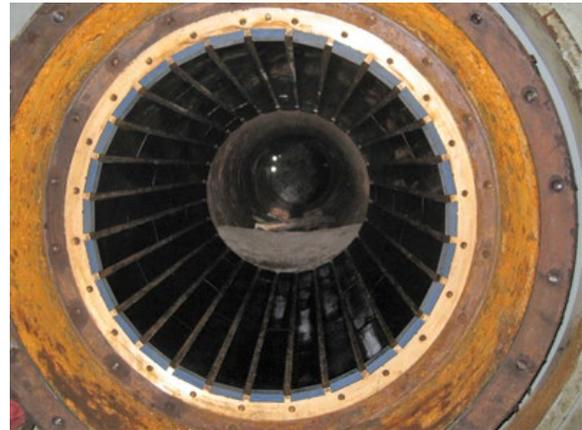
Sistema lubricado por agua diseñado para disipar el calor de los rodamientos, reducir la fricción y expulsar arenilla y contaminantes marinos, alargando la vida de los rodamientos y del exterior del eje.
