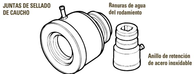
Otro tipo de sellado mecánico muy común utilizados en los ejes de las hélices son las juntas de sellado. Las juntas de sellado son, en cierto modo, similares a los prensaestopas; utilizan los ejes de la hélice como una superficie de sellado. Un anillo de caucho con una junta en el diámetro interior se ajusta al eje de la hélice. El ajuste a presión entre las juntas de caucho y los ejes de la hélice garantiza un contacto continuo creando un sello.
